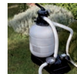
Filtro de arena | Sand filter | Epurateur sable
